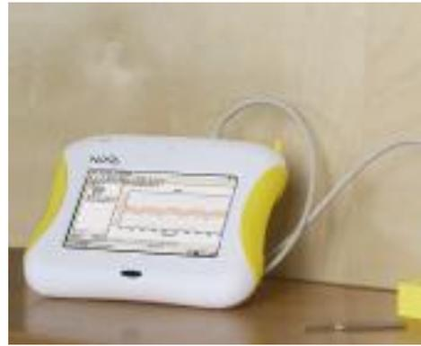
Рисунок 1 – Оборудование для измерения освещённости
