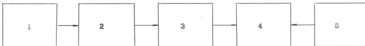
Рисунок 4 – Электрическая структурная схема измерителя плотности потока мощности: 1.Антенна; 2.Аттенюатор; 3.Терморезисторная головка; 4.Измеритель мощности; 5.Источник питания.
