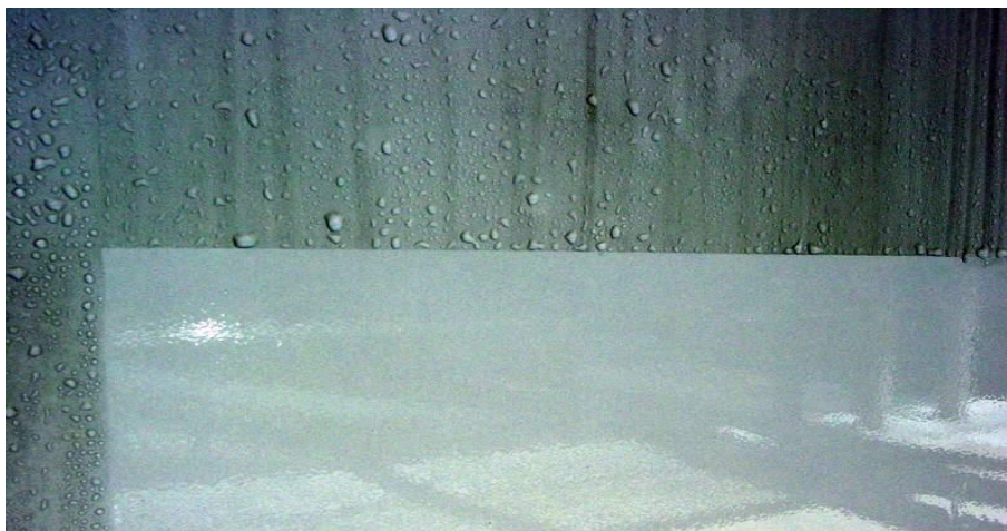
Рисунок 1 – Самоочищающееся фотокаталитическое покрытие SolarStucco
