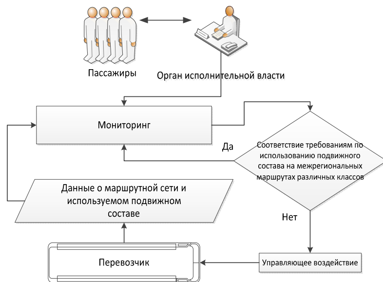
Рисунок 3 - Проект системы взаимодействия между выделенными объектами в области подбора оптимального подвижного состава для осуществления межрегиональных автобусных перевозок
