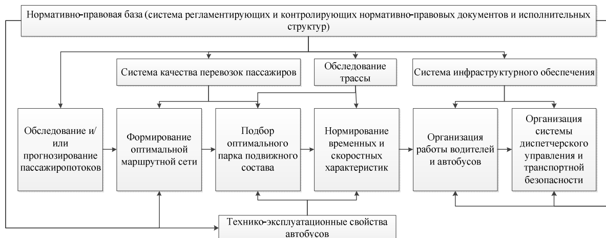
Рисунок 1 - Система организации межрегиональных автобусных перевозок, разработанная на кафедре «Автомобильные перевозки» МАДИ
