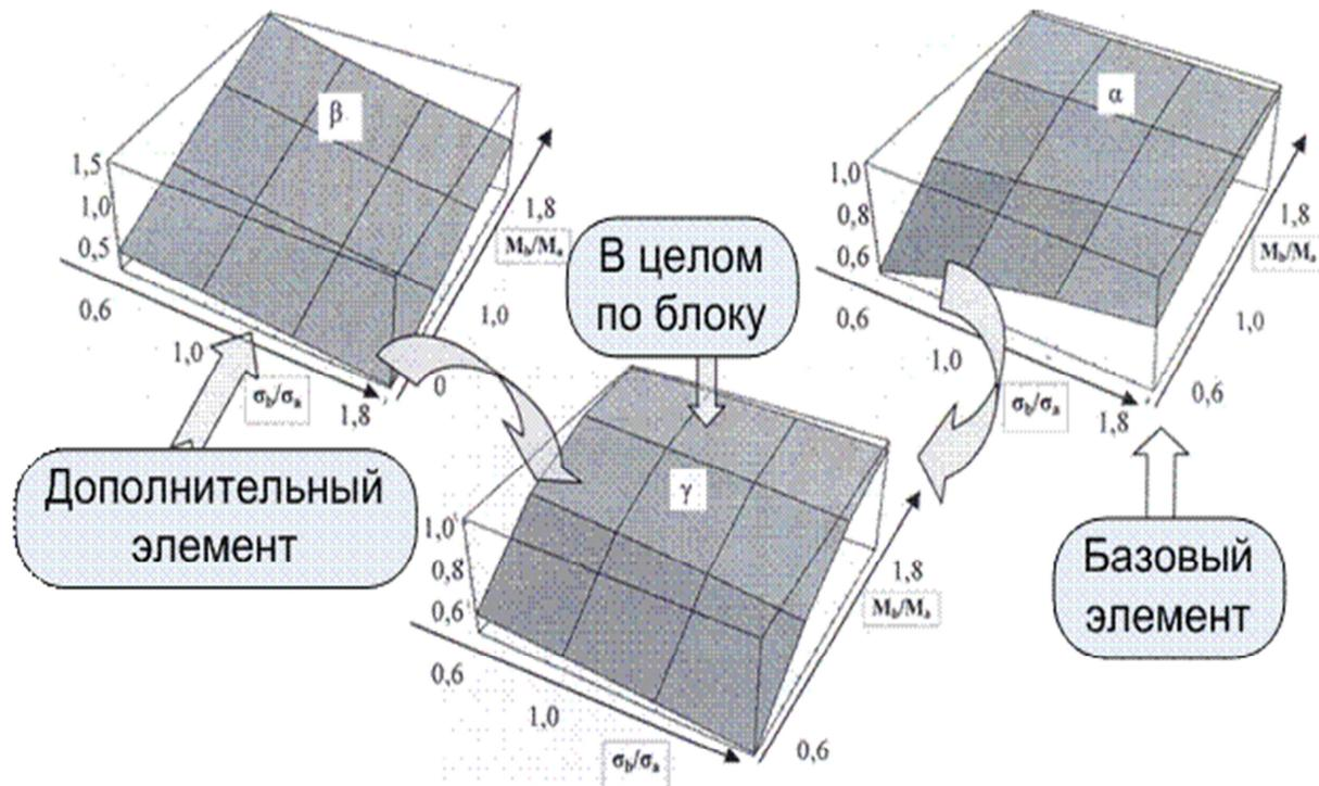
**Рисунок 1 - Математическое ожидание наработки на отказ элементов и блока в целом при восстановлении работоспособности по стратегии 2**
