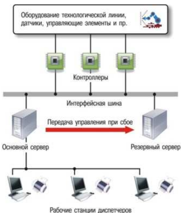
Рисунок 1 - Топологическая схема организации SCADA-системы
