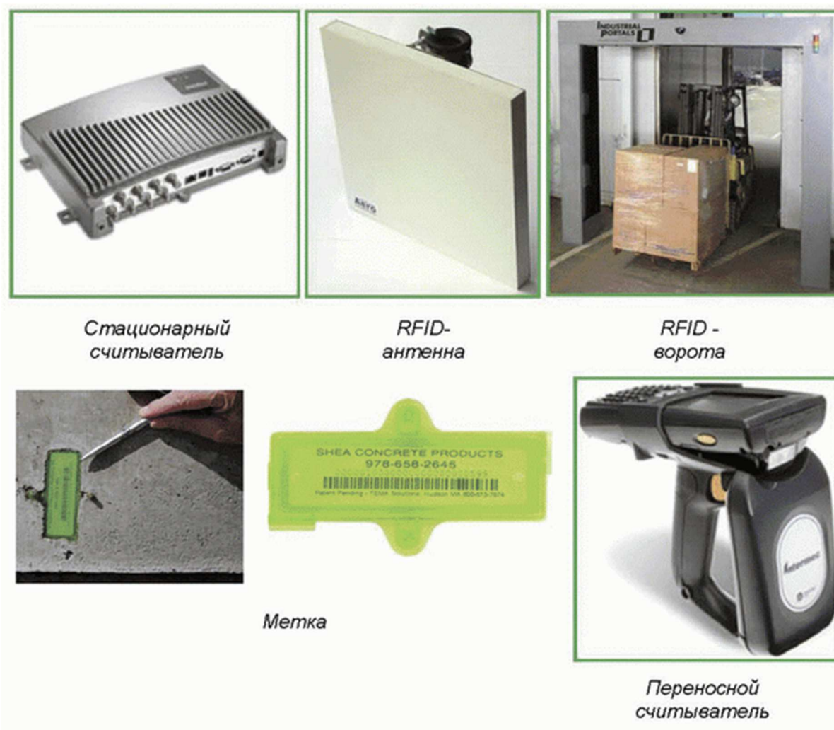
Рисунок 2 - Устройства и технические средства автоматизированной системы управления складом железобетонных изделий
