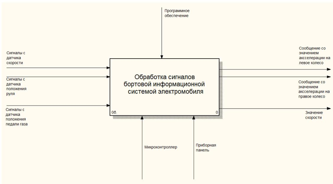
**Рисунок 3 - Функциональная схема ИС**
