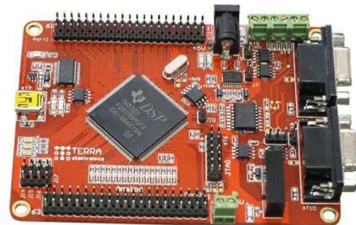
Рисунок 7 - Встраиваемый модуль TE-TMS320F28335
