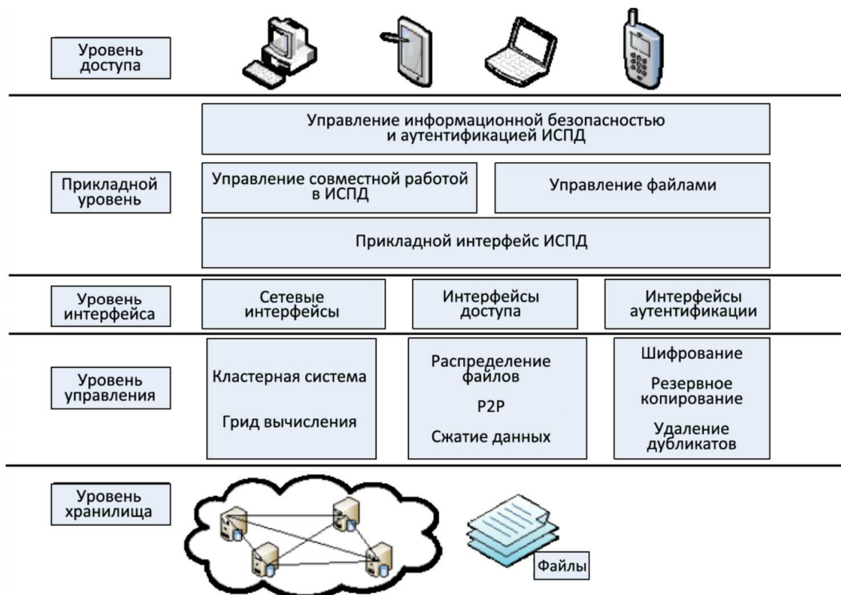
Рисунок 3 – Схема облачного хранилища ИСПД
