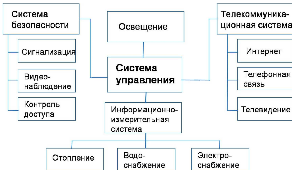
Рисунок 1 – Принципиальная структура "Умного дома"
