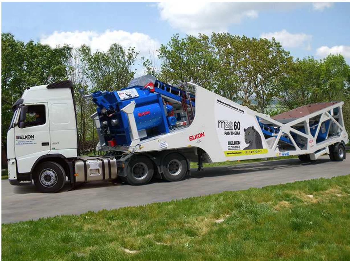
Рисунок 2 – Мобильный бетонный завод
