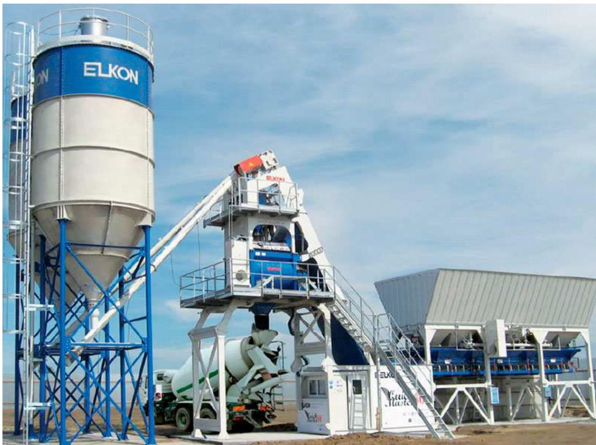
**Рисунок 3 – Быстромонтируемый бетонный завод**
