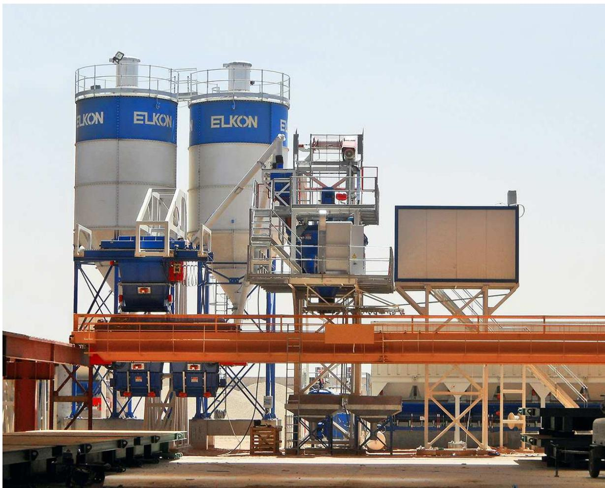
**Рисунок 4 – Завод с адресной подачей бетона на производство железобетонных изделий**
