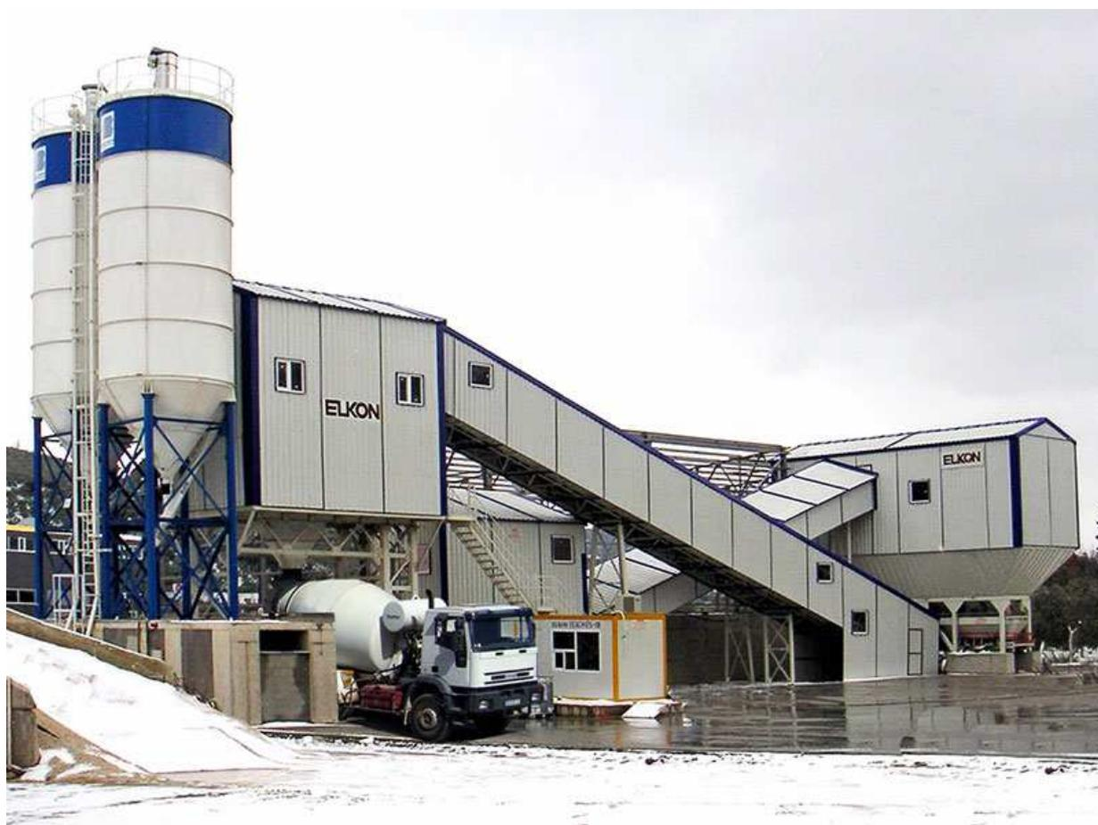
Рисунок 1 – Стационарный бетонный завод
