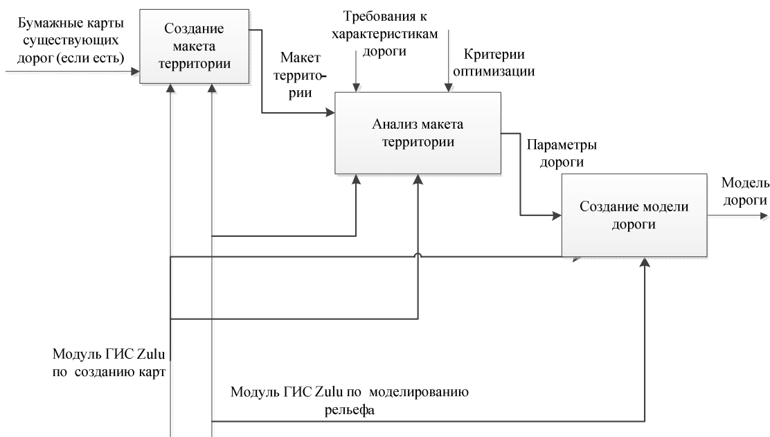
Рисунок 15 – Диаграмма декомпозиции процесса проектирования дорог
