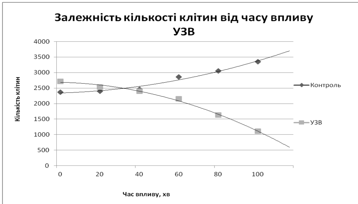
Рис.1. Динаміка зміни популяції дріжджів від часу впливу ультразвуковим випроміненням
