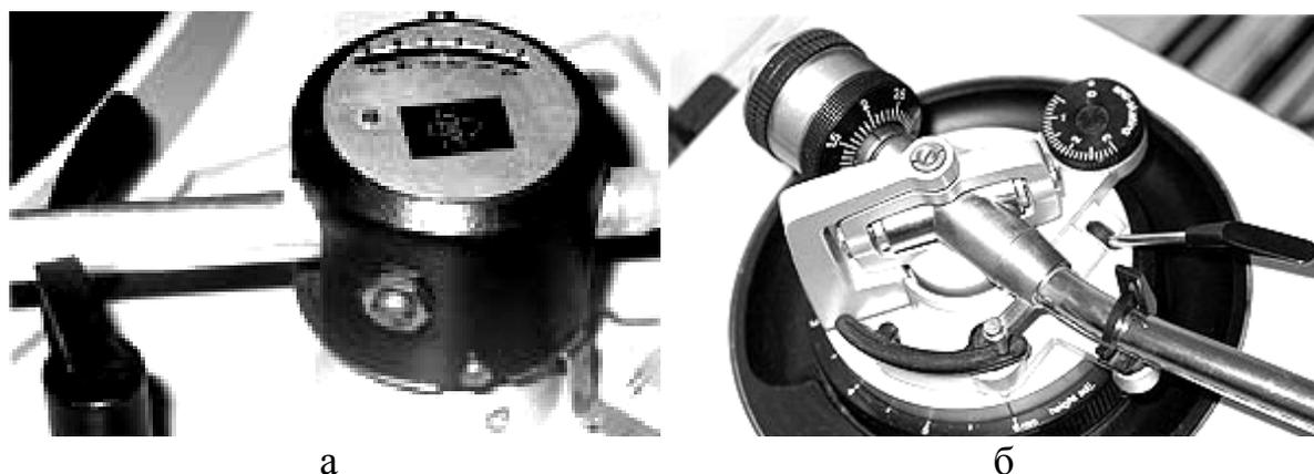
Илл. 4: Регуляторы: а) регулятор давления ЕМТ, б) регулятор угла наклона<sup>1</sup>.
