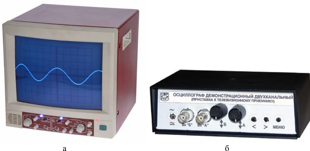
Рис 2. Демонстрационные осциллографы: а) в корпусе; б) приставка к телемонитору.
