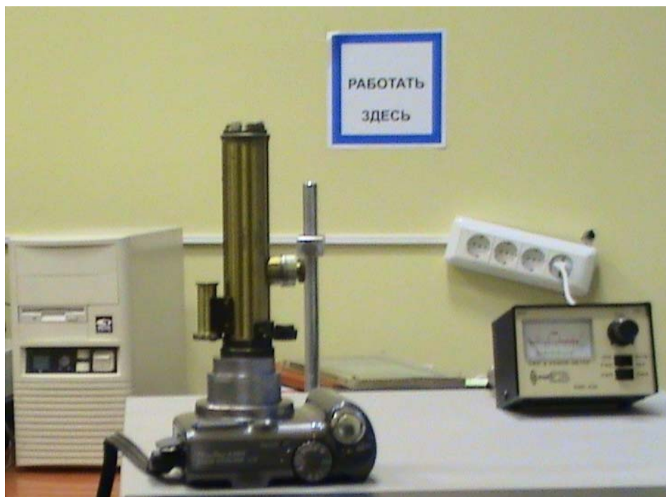
Рис. 8: Оптическая часть установки и КСВ - метр.
