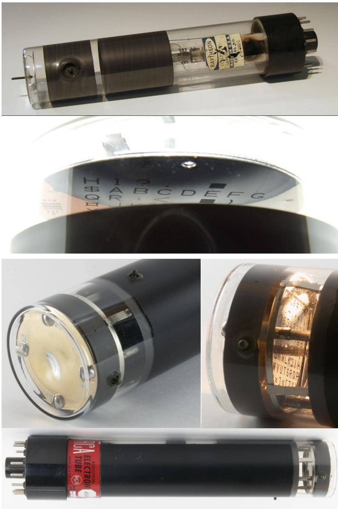
Рис. 2. Примеры моноскопических электронно-лучевых трубок и изображения их паттерн-генераторов.
