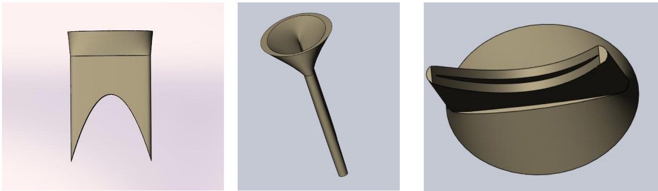
Рис. 4 – Модель клапана у закритому стані: а) вид спереду; б) вид збоку; в) вид знизу
