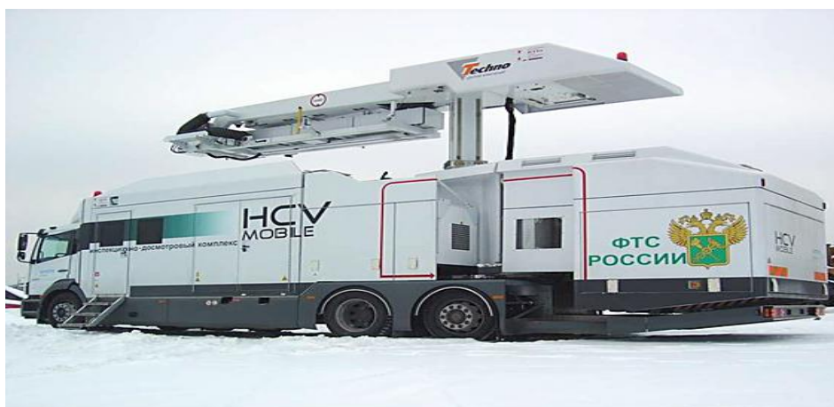
Рис. 1 - Мобильный инспекционно – досмотровый комплекс HCV MOBILE.
