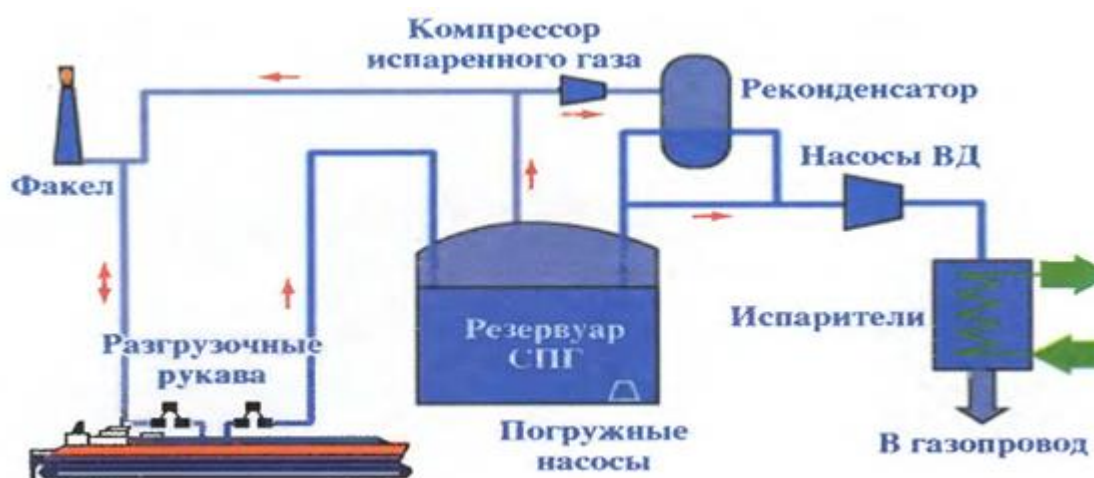
Рисунок 1- Принципиальная схема регазификационного терминала
