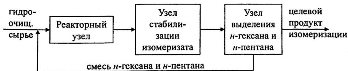
Рисунок 6 - Блок-схема процесса в рециклом n -пентана и n -гексана
