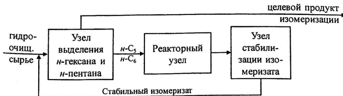
Рисунок 7 - Блок-схема процесса с выделением n -пентана и n -гексана методом адсорбции из сырья
