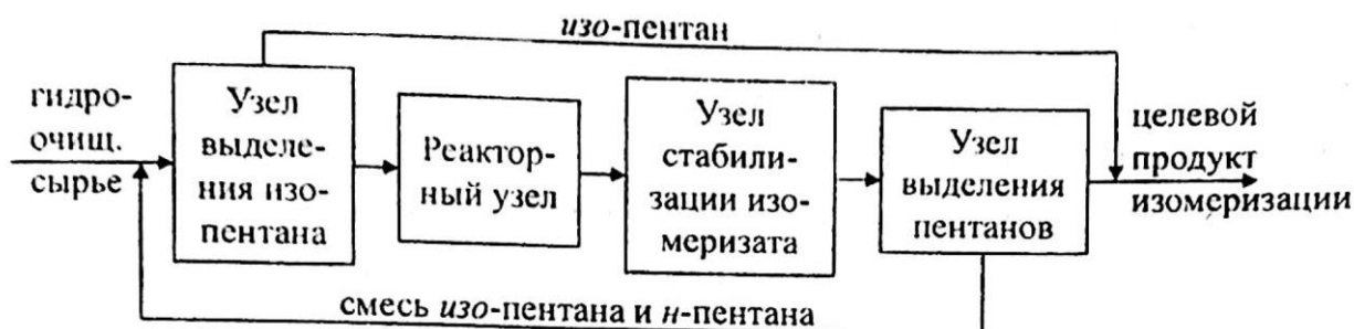
Рисунок 4 - Блок-схема процесса с рециклом n -пентана и деизопентанизацией сырья
