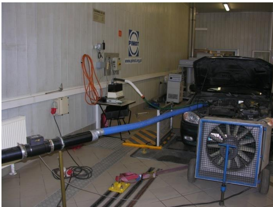
Рисунок 19 – Фотография испытательного стенда (видимый стенд для испытаний двигателя шасси, подачи воздуха, подачи водяного пара и анализатора выхлопных газов) [67]
