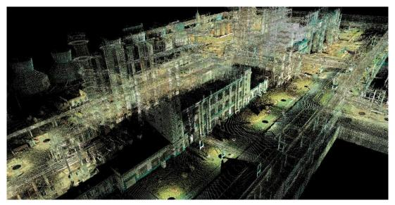
2. Локальное сканирование. Выполняется на небольшом участке промышленного объекта, когда нет необходимости сканировать весь объект. Например, при необходимости демонтажа и замены лишь одного трубопровода. В этом случае фазовыми сканерами детально сканируется лишь исследуемый трубопровод, его опоры, подвесы и для обстановки — прилегающая зона в несколько метров.
