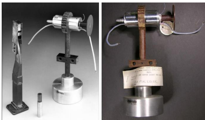
Рисунок 1. Фотографии одной из возможных версий первого рубинового лазера Теодора Меймана (Национальный музей американской истории) [2]
