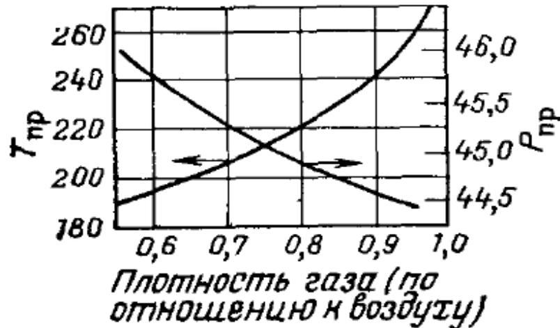
Рисунок 8 - Зависимость псевдокритических параметров смеси углеводородных газов от ее относительной плотности
