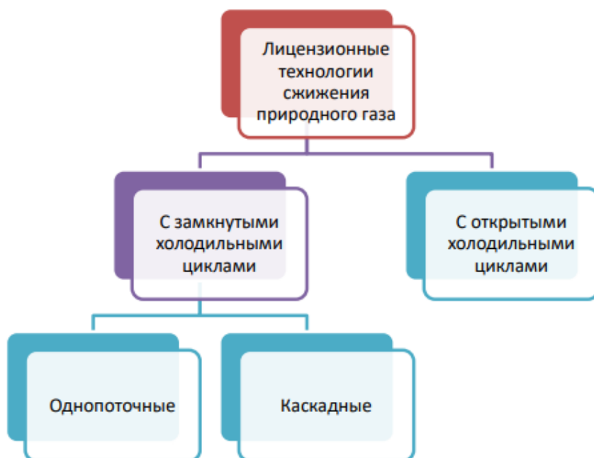
Рисунок 8 – Деление технологий сжижения на группы в соответствии с особенностями холодильных циклов
