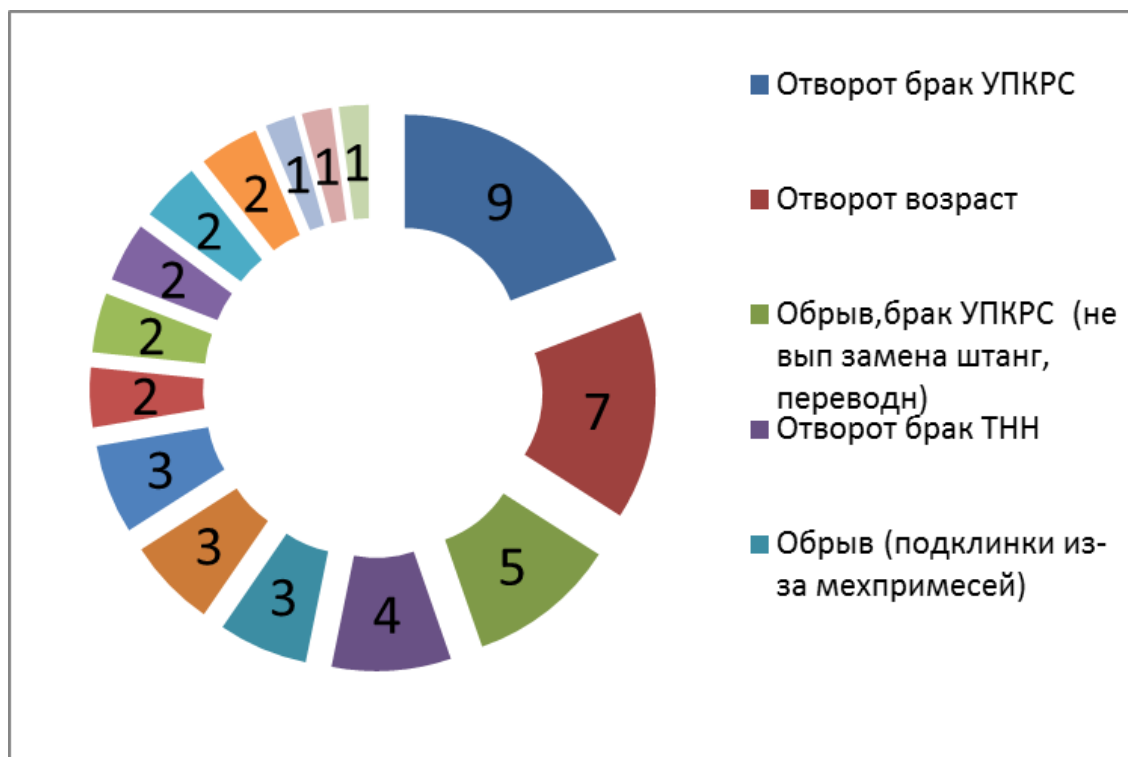
Рисунок - 5. Распределение отказов Штанг
