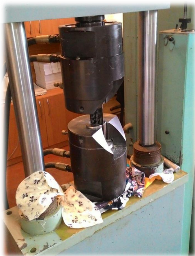
Рис. 2 - Разрывная машина. ЛДИ ПАО «Роствертол»
