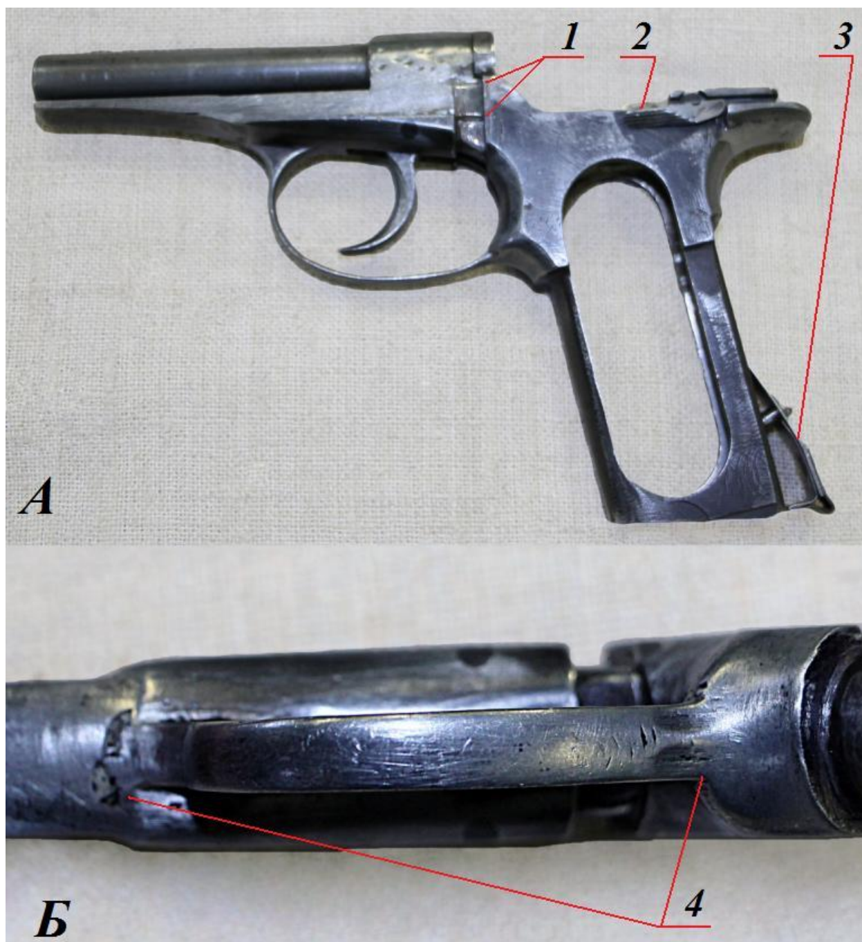
Рис. 3. Рамка и спусковая скоба «пистолета гражданского типа», вид слева, Б — вид передней нижней части спусковой скобы крупным планом. 1 — пропилы, исполненные трехгранным напильником; 2 — затворная задержка; 3 — пластинчатая пружина; 4 — следы зачищенных швов.
