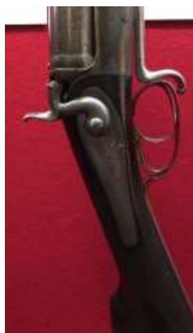
Рис. 3.2. Обратный замок ( Back action ). (Фотография любезно предоставлена компанией James Purdey & Sons).
