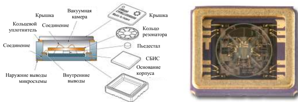
Рис. 1 Устройство используемого ММГ (слева) и его фотография со снятой крышкой (справа)
