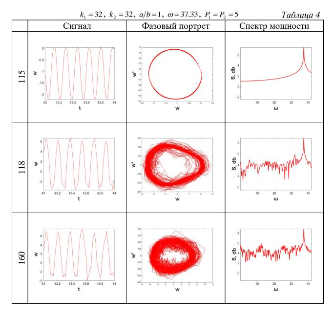
В табл. 3 и табл. 4 приведены результаты по численному исследованию динамического поведения оболочки при  $p_1=p_2=5$  для безразмерных параметров кривизны  $k_1=k_2=16$  и  $k_1=k_2=32$  соответственно. При этом частота вынуждающей нагрузки опять выбиралась близкой к численно определяемым собственным частотам данных конструкций:  $\omega=22.95$  и  $\omega=37.33$  соответственно.
