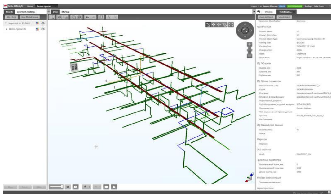
Рис. 10. Project Studio CS CKS. Модель системы в формате IFC, открытая в Tekla BIMsight
