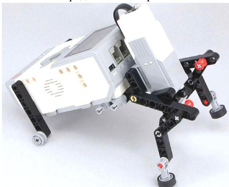
Рис. 1. Простейшая конструкция шагающего робота
