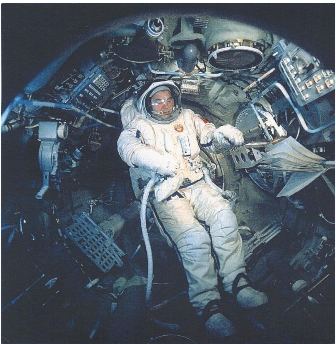
На «Салюте-6». К выходу в открытый космос – готов. Но не через выходной люк, а через стыковочный узел, чтобы проверить электро- и гидроразъемы. Это так же, как на подводной лодке: обычный выход через рубку. А в аварийной ситуации – через торпедный аппарат
