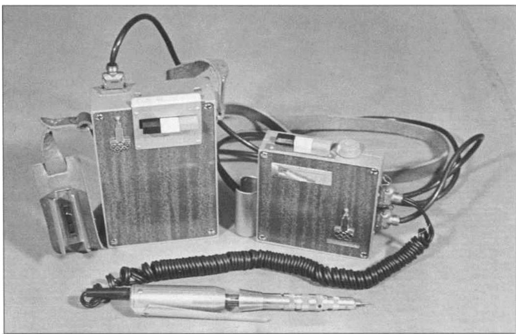
**Рис. 6.** Общий вид портативных бормашин с автономным питанием (слева) и от бортовой сети – «мечта стоматологов»
