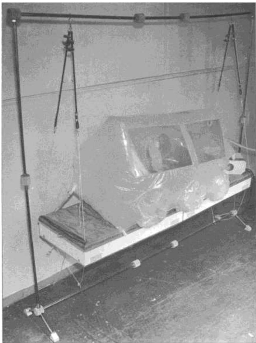
**Рис. 10.** Общий вид операционной панели с гнатобиологической камерой в рабочем положении
