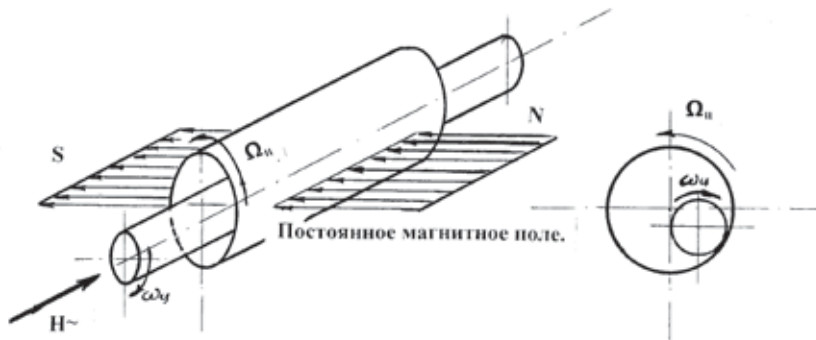
Рис. 10. Скрещивание постоянного и переменного магнитных полей, неподвижных относительно ферритового цилиндра - 1. вызывает вначале раскачивание, а потом беспорочное его вращение, совершая планетарное движение относительно ограничительного цилиндра из немагнитного материала - 2. (По Фурмакову Е.Ф.)
