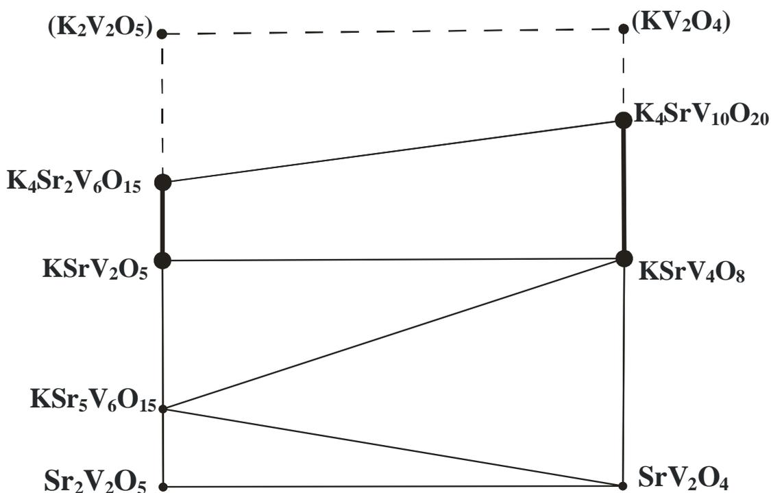
Рис. 1 Фазовая диаграмма системы  $(\text{KV}_2\text{O}_4) - (\text{K}_2\text{V}_2\text{O}_5) - \text{Sr}_2\text{V}_2\text{O}_5 - \text{SrV}_2\text{O}_4$ .
