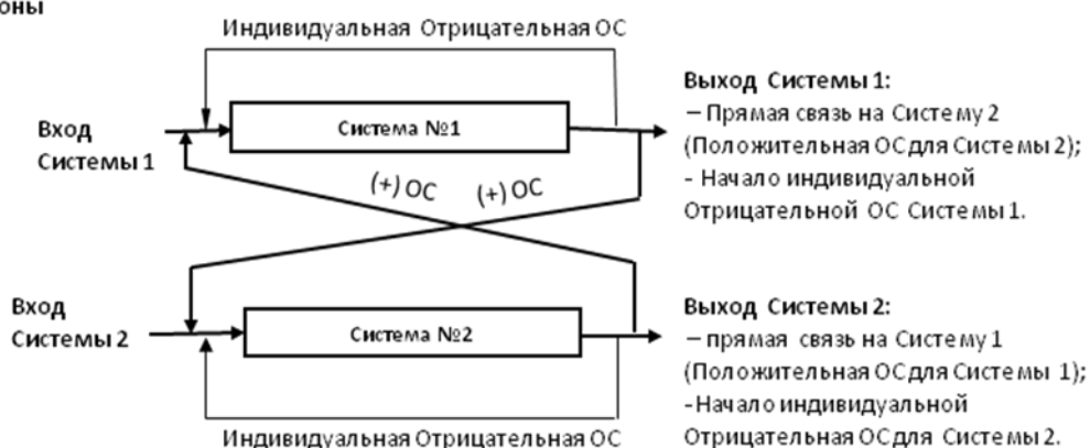
Рис. 61. Компенсационный двусторонний гомеостат по инверсному взаимодействию надсистемы образованной двумя системами
