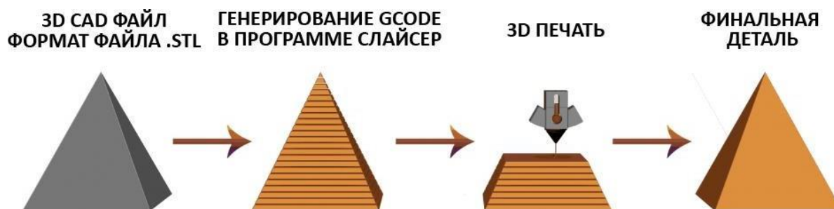
Рисунок 2 – Этапы печати на принтере с FDM технологией
