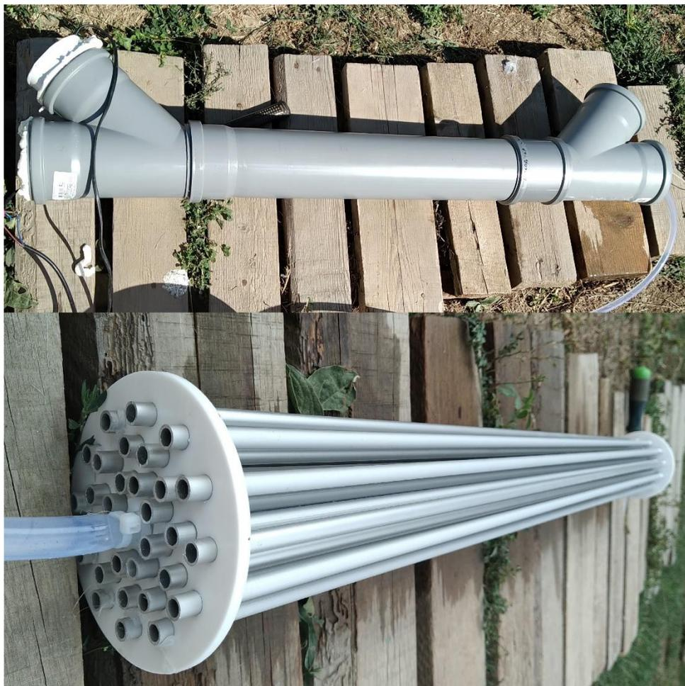
Рисунок 2 – Рекуператорно-охладительная установка на основе М-цикла
