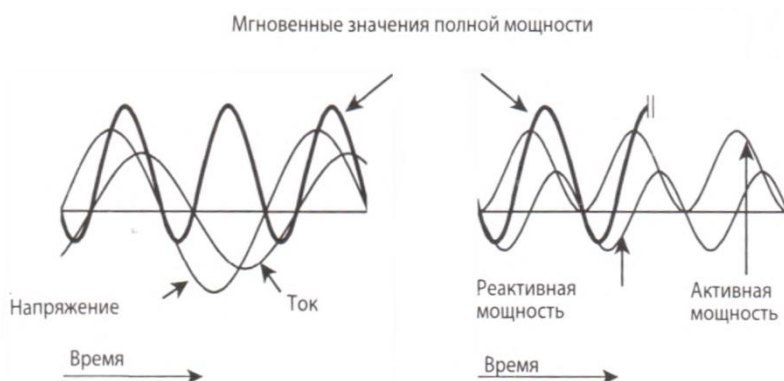
Рисунок 1 – Активная и реактивная составляющая полного потока мощности
