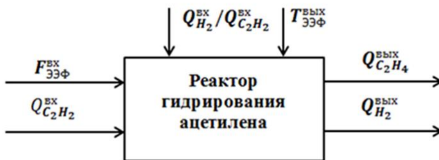
Рис. 1. Реактор гидрирования ацетилена как объекта управления
