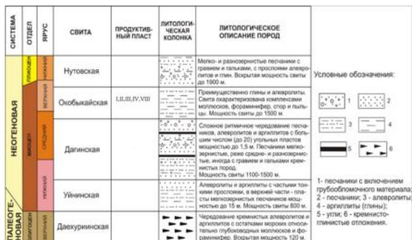
Рисунок 1 – Литолого-стратиграфический разрез месторождения
