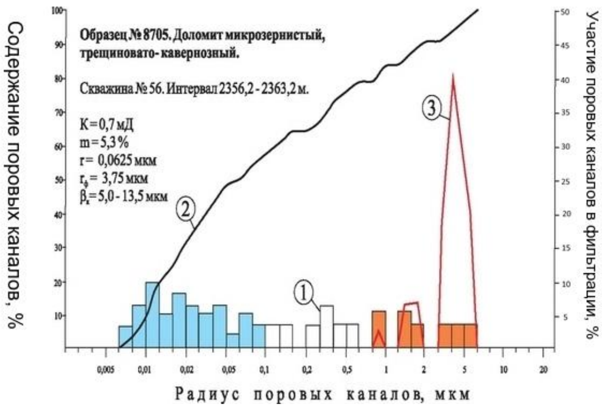
Рисунок 5 – Порометрическая кривая образца № 8705
