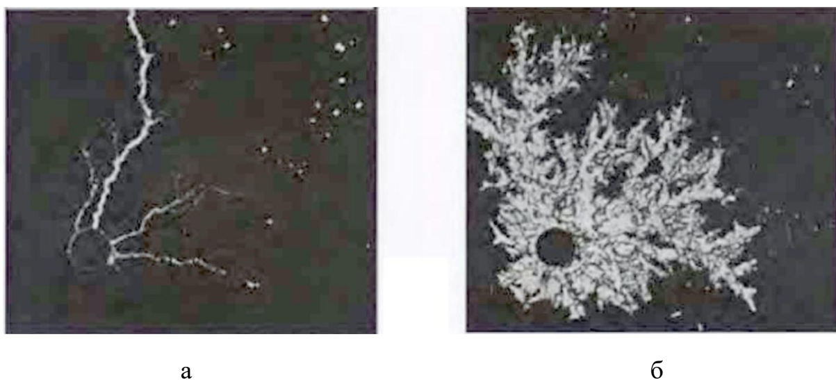
Рисунок 3 – Образование «червоточин» в известняке (а) и доломите (б)
